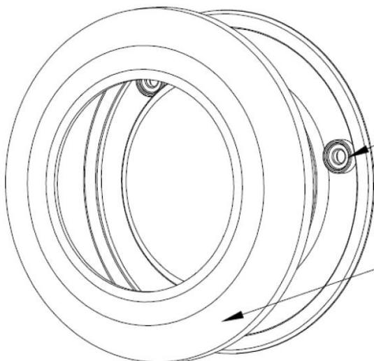
Montage des kapazitiven Tasters mit drei Zylinderkopfschrauben M4
